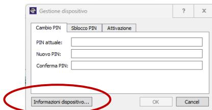
Si aprirà la finestra “Informazioni dispositivo” con le informazioni del tipo di chip e del produttore. I chip vengono identificati dai seguenti dati:
